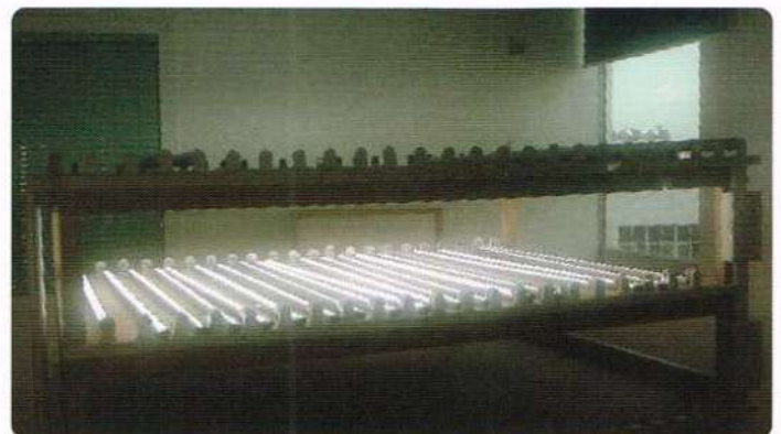
長時間の点灯検査を行なっています。
